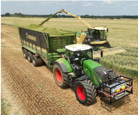
*Bild: Umgerüsteter Fendt 936 der RUHE Gruppe mit Bio-LNG Front-Tank*
